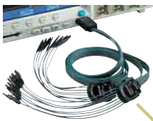
16デジタル・チャンネルを使いI 2 CとSPIバスを同時に解析した例
